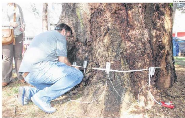
Fixação de sensores no entorno do tronco da árvore centenária localizada na Praça Rui Barbosa: laudo fica pronto em breve
